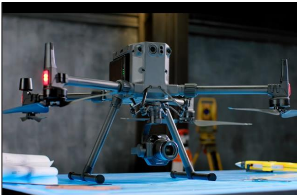
Abbildung 3: Vermessungsdrohne, Modell: DJI M300 RTK
